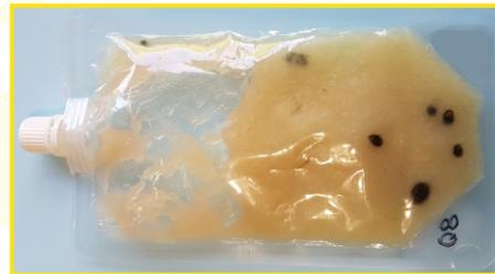
**Quanti-P/A** para recuento de *Clostridium perfringens* en 100 ml de agua o 1 g de alimento sin necesidad de filtración, ni de atmósfera de anaerobiosis, ni de fundir/enfriar medios
