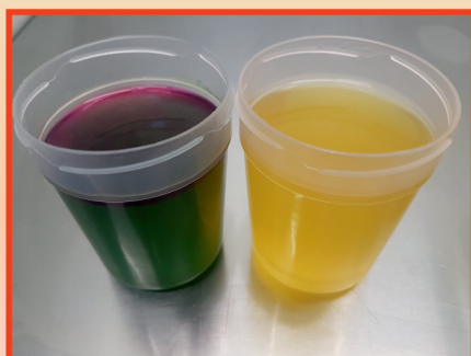
Colicult-Plus (Caldo ISO-9308 con cromógeno adicional): Despistaje de E. coli (viraje a verde sin malinterpretaciones de fluorescencia; e indol rojo) y demás Coliformes (viraje a amarillo) en 100-250 mL de agua
