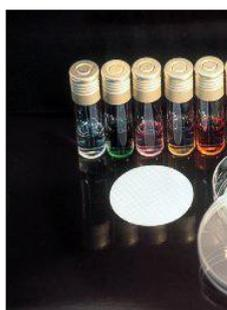
A la derecha, Unidad de Filtración MICROKIT: viales, placas, cartones y membranas para MF.
