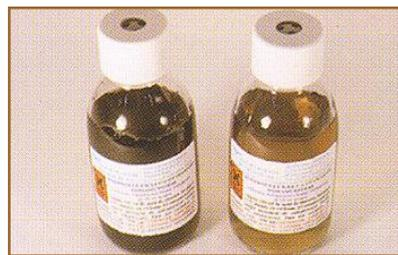
Es necesaria la ausencia (no viraje), que equivale a 0 ufc/100 mL (ó en 50 mL). Sólo en caso positivo debería repetirse la muestra por método cuantitativo si se requiere un recuento concreto, aunque la legislación exige 0 y por tanto no importa si hay 2 ó 950, en ambos casos el agua no es potable. Si aún así debe cuantificar (muestras positivas con Enterocult P/A), utilice Quanti-P/A-ETC (Ref: QPA-ETC), que contienen este mismo medio con gelificantes en frío en una bolsa hermética.
