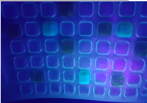
Uso de Colicult-ISO en cubetas NMP bajo UVA de 366 nm: 3 pocillos fluorescentes: E.coli
