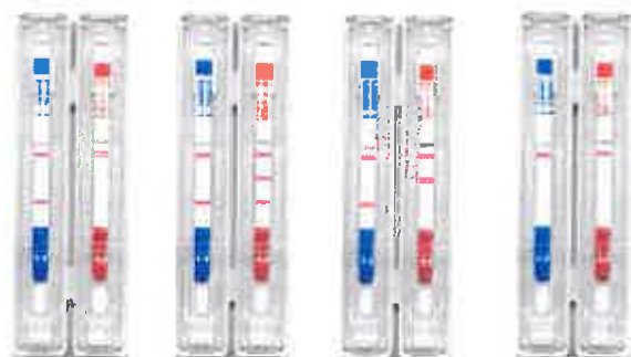
LEGIONELLA GÉNERO POSITIVO L. PNEUMOPHILA SEROGRUPO 1 POSITIVO L. PNEUMOPHILA SEROGRUPOS 2-15 POSITIVO NEGATIVO
