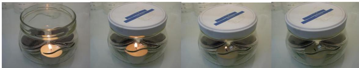
Agotamiento del oxígeno y enriquecimiento en CO<sub>2</sub> en jarrita de microaerofilia,, en sólo unos segundos, mediante el sistema de la vela.
