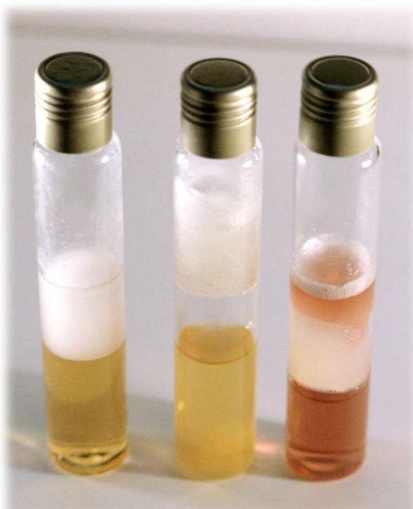
Izda: Tubo negativo. Centro: Tubo positivo, caldo turbio y gas que separa el tapón de parafina. Dcha: Medio oxigenado, tubo invalidado.
