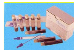
TUBOS P/A REVITALIZACIÓN LEGIONELLA
